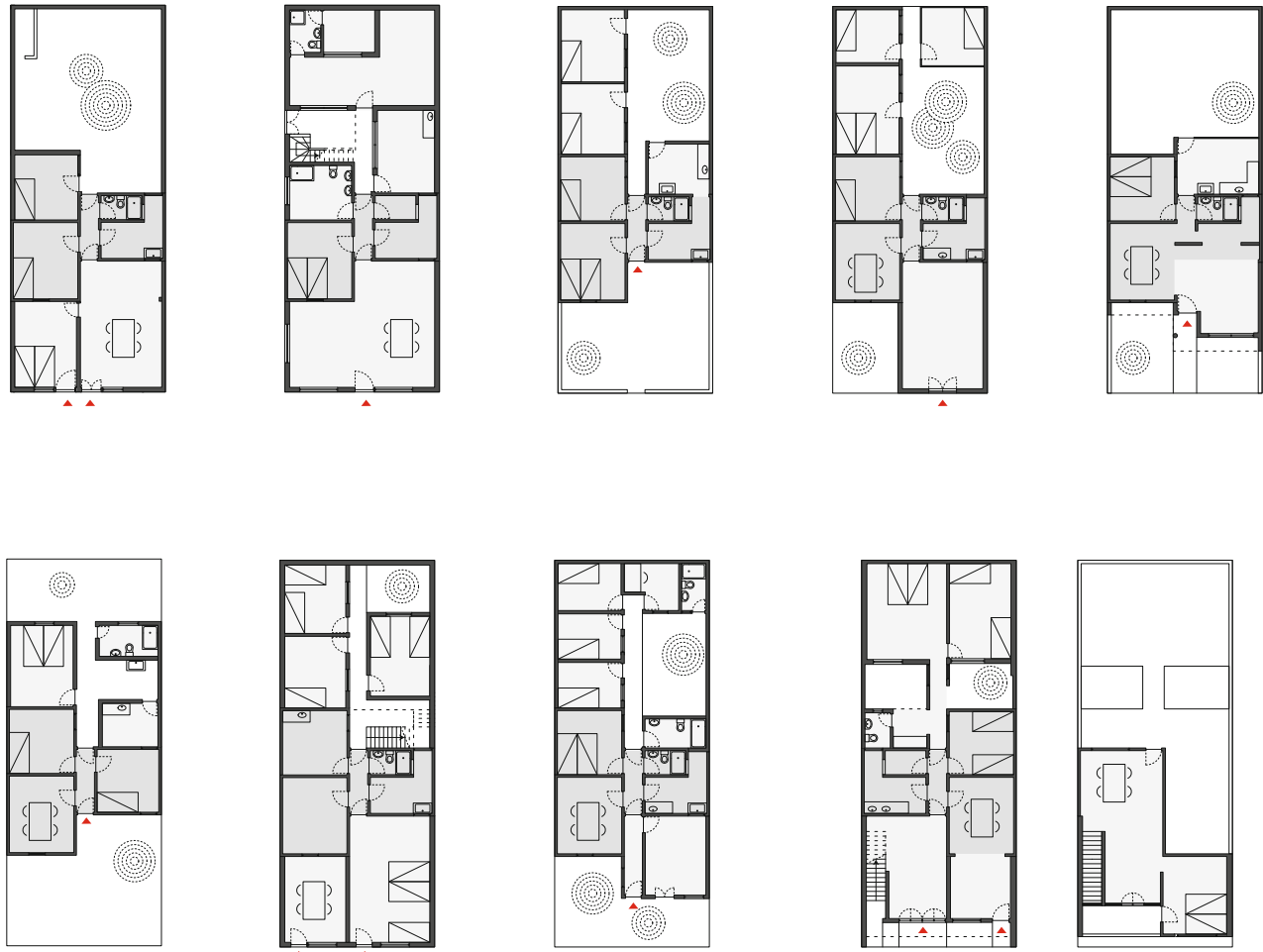
Woninguitbreidingen zoals aangetroffen tijdens de evaluatie door het Ministerio de Vivienda, 1970 Dwelling extensions as found during the evaluation by the Ministerio de Vivienda, 1970
